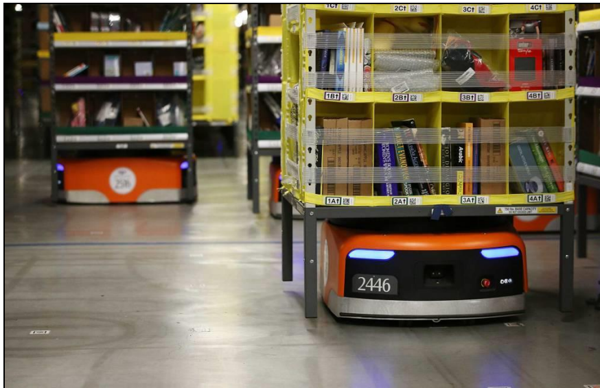
Рис. 1. Роботизована система вантажників «Kiva» [2]
